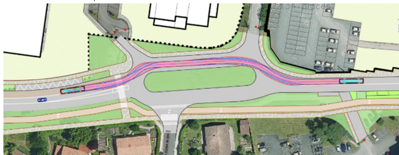
Figure 28 : Epure de giration d'un bus simple dans le giratoire oblong
