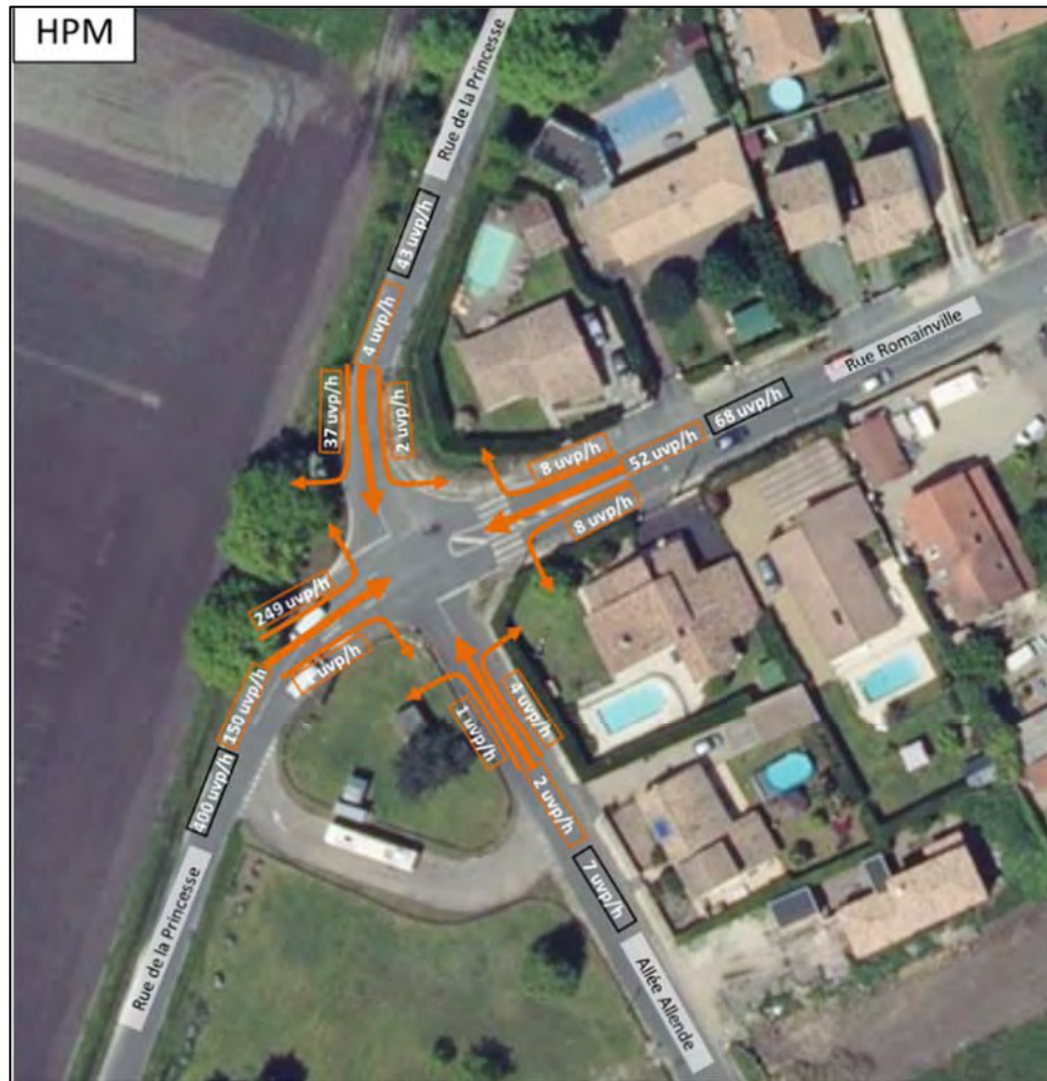
Figure 12 : Comptages directionnels HPM au droit du carrefour Princesse x Romainville (source : CPEV, 2021)
