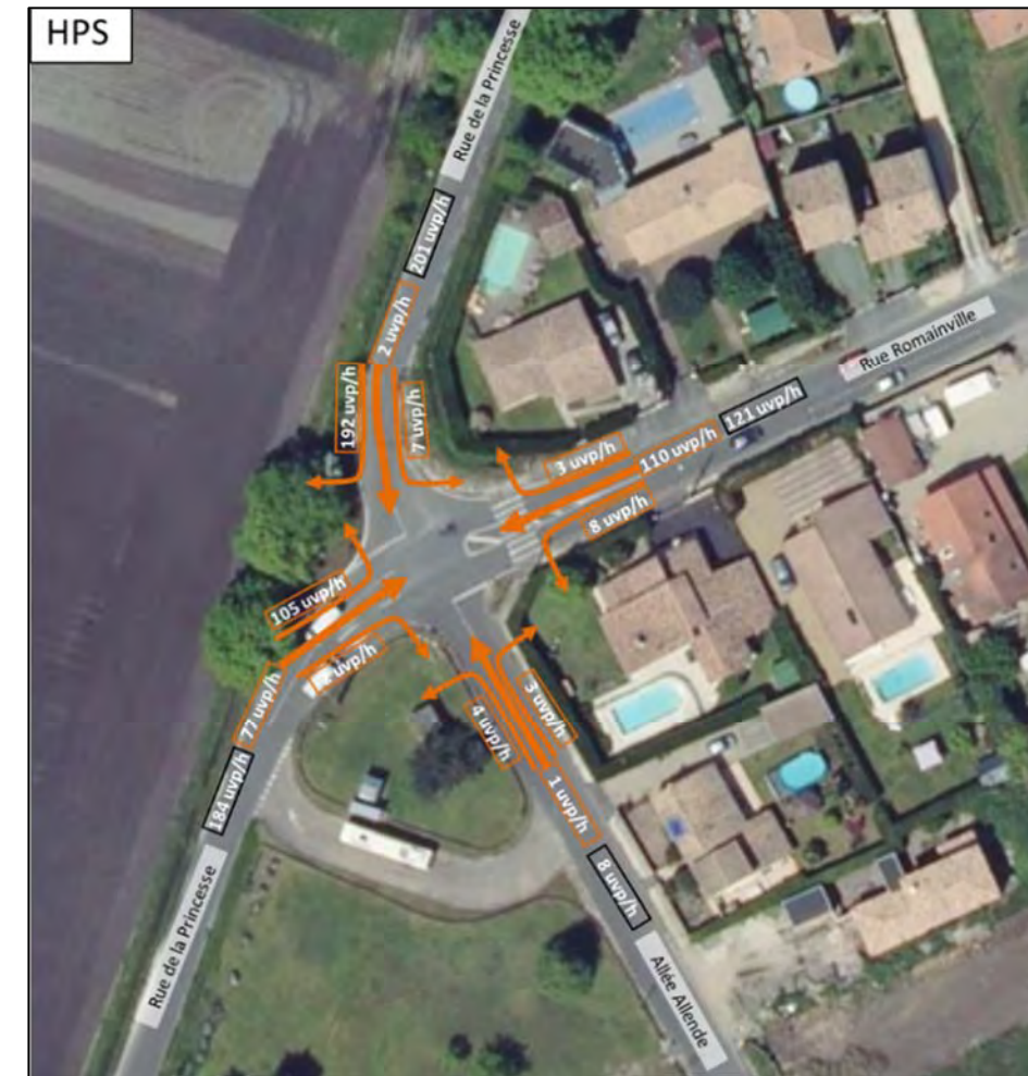
Figure 13 : Comptages directionnels HPS au droit du carrefour Princesse x Romainville (source : CPEV, 2021)
