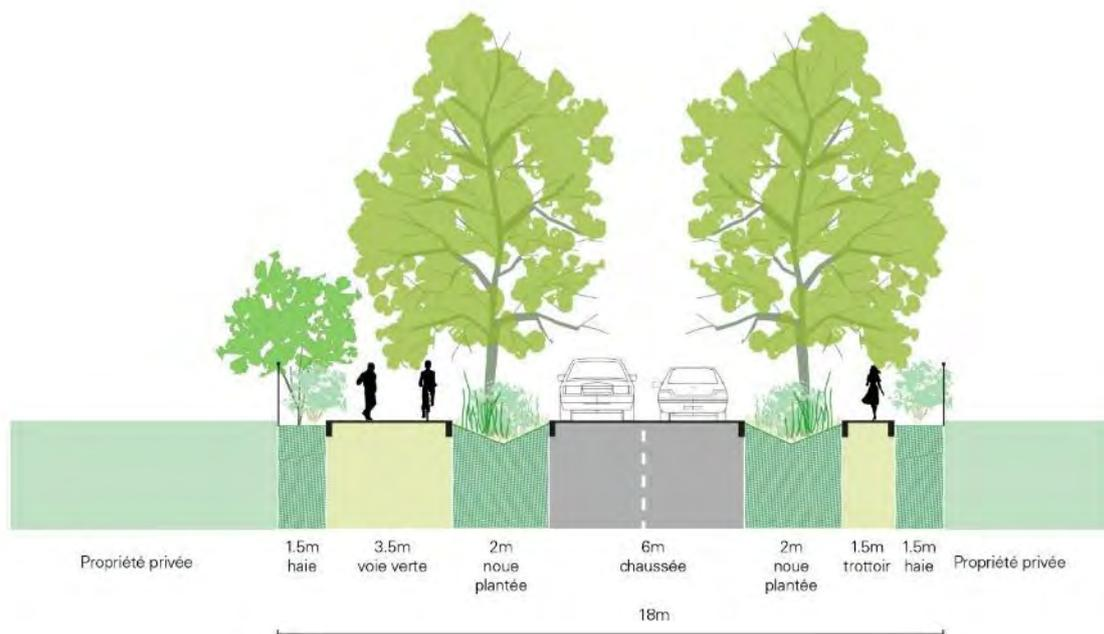
Figure 376 : Profil-type retenu de la voie Thales
