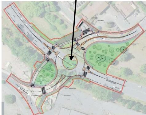
Implantation d'un giratoire sur l'avenue René Cassin et dans le prolongement de la rue Euler
