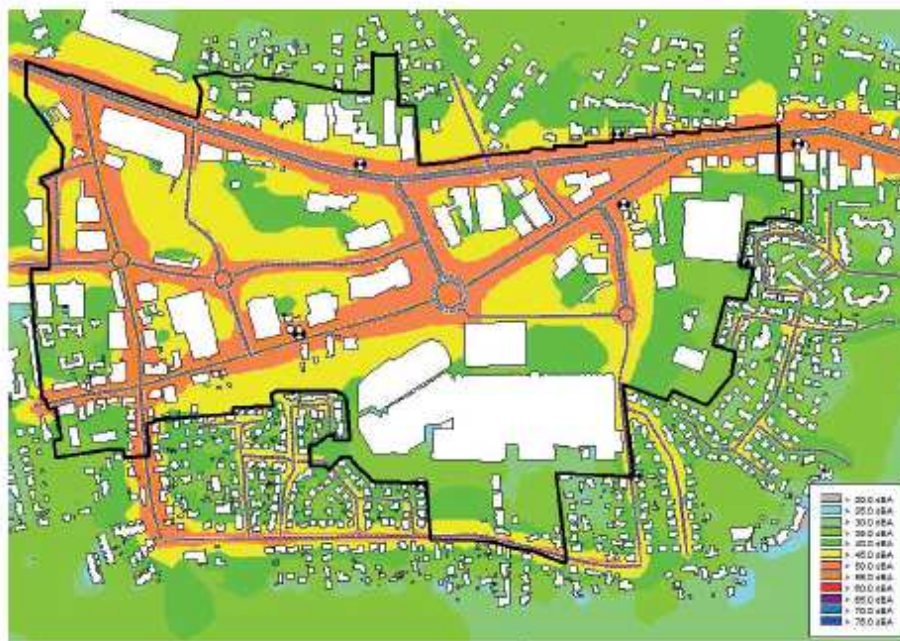
Cartographie de bruit à l'état actuel, période nuit- Source: Étude acoustique, VENATHEC, décembre 2017
