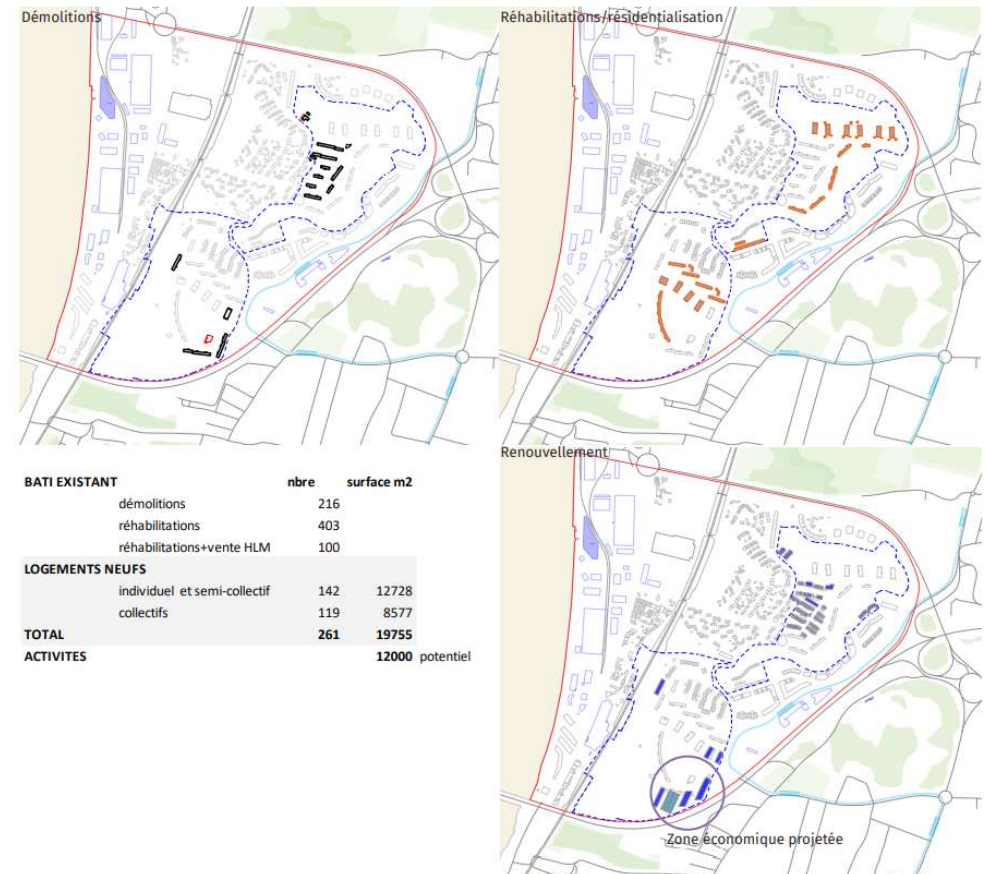
Figure 2 : Ensemble des opérations de démolitions, réhabilitations, résidentialisation et des constructions neuves (Plan guide révisé 2022)
