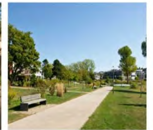
Stabilisé renforcé sur cheminement secondaire pour modes doux
