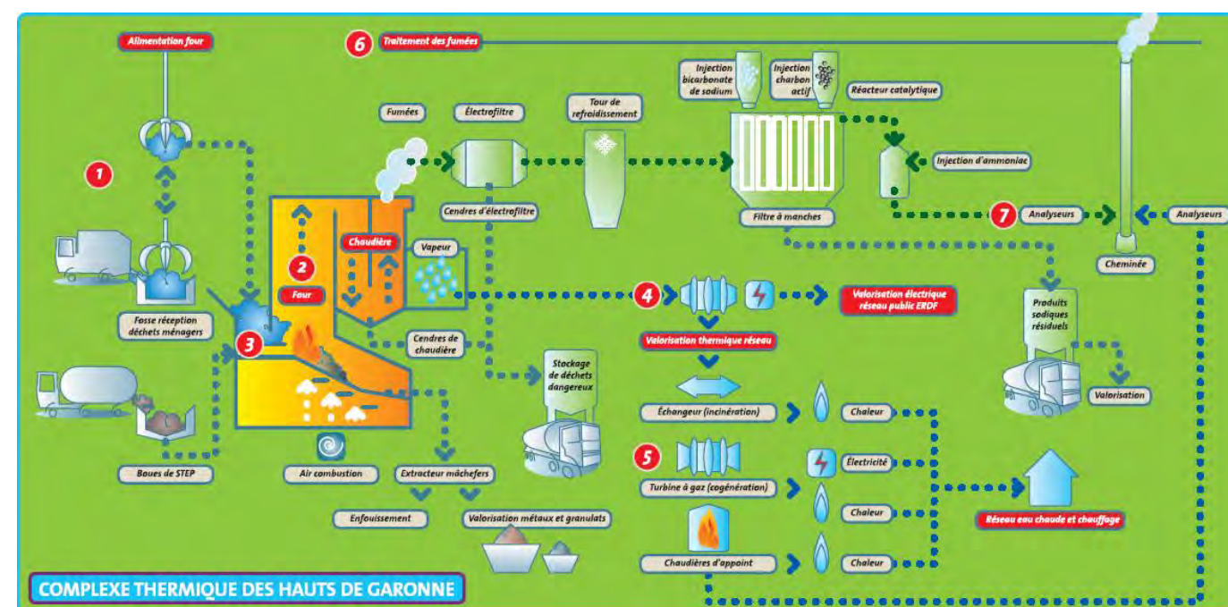
Figure 90 : Fonctionnement du complexe thermique des Hauts de Garonne (source : SIVOM rive droite)
