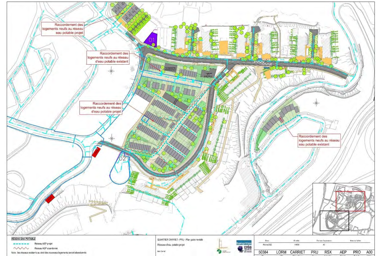
Figure 182 : Réseaux d'adduction d'eau potable au niveau du Bas Carriet
