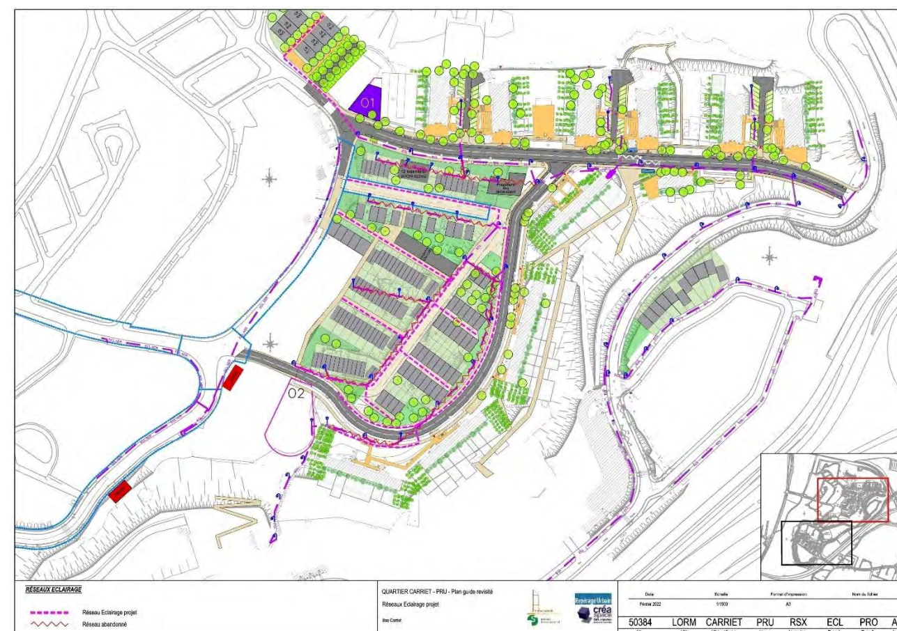
Figure 178 : Réseaux d'éclairage public au niveau du secteur Bas Carriet sur la ville de Lormont
