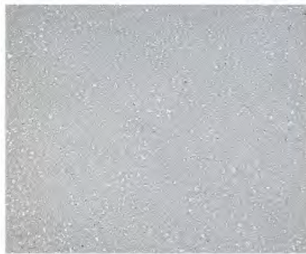
Béton hydrosablé clair pour trottoir
