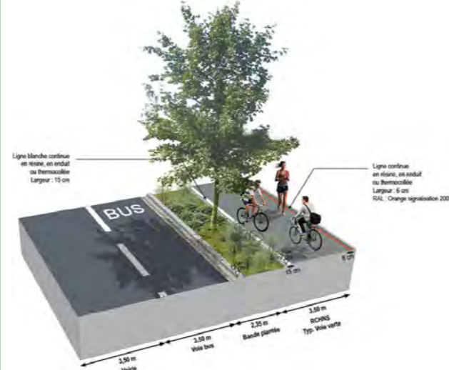
Insertion du ReVE en piste cyclable bidirectionnelle
