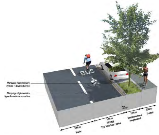
Insertion du ReVE en piste cyclable avec stationnement longitudinal
