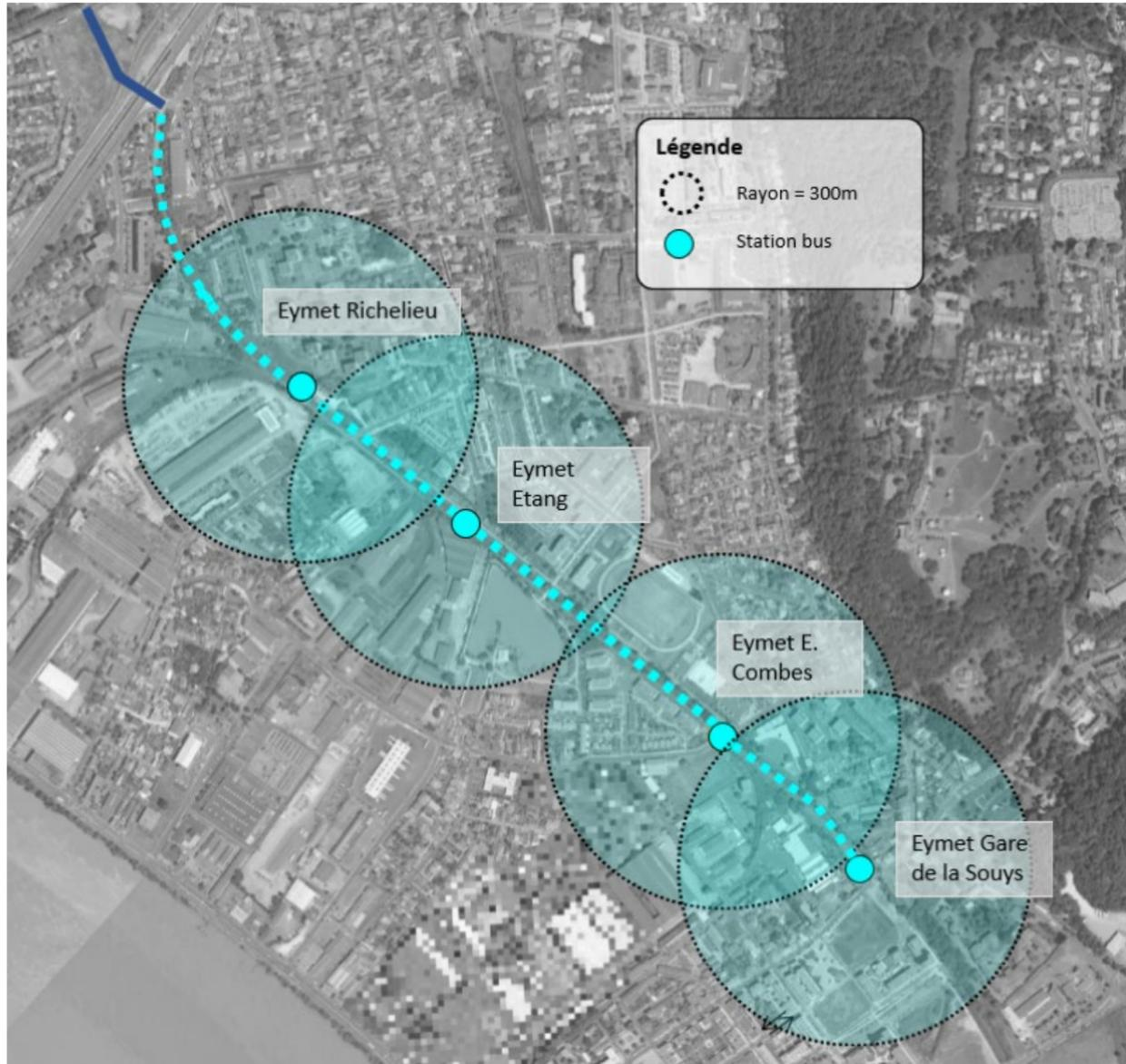
Figure 17 : Synoptique des stations bus projetées sur la voie Eymet
