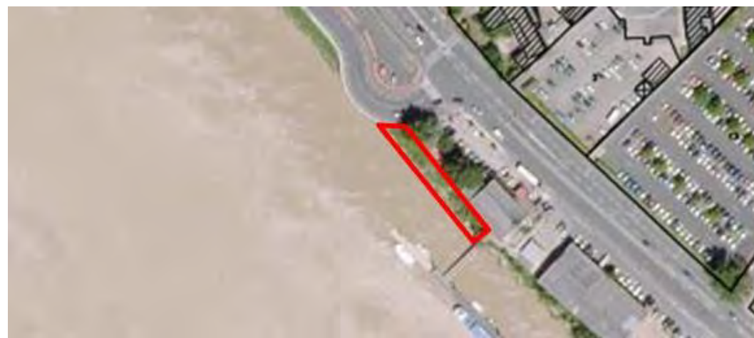
Emprise des travaux sur le secteur Café du port, les accès chantier se faisant par voie fluviale
