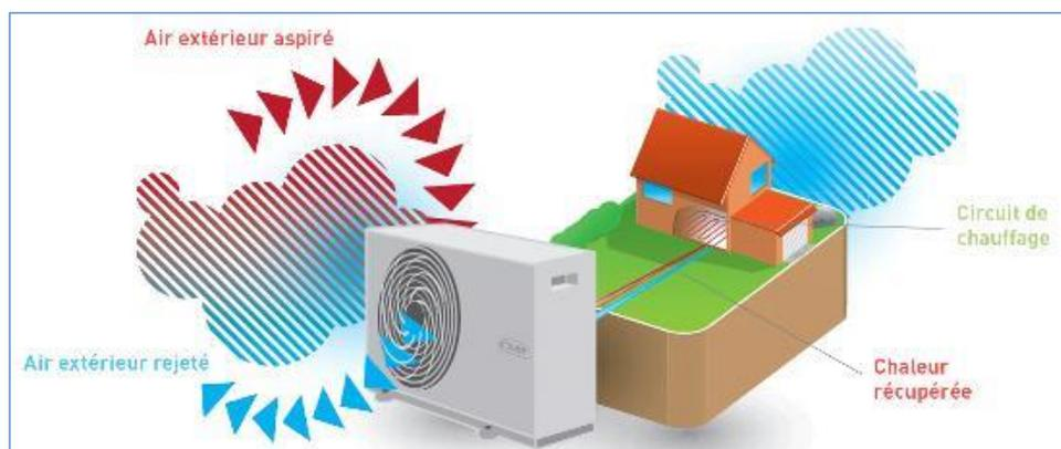
**Schéma de fonctionnement d'une pompe à chaleur air/eau**
