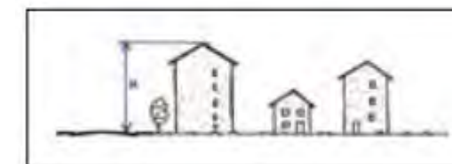
Consiste à fixer aux bâtiments situés le long de l'infrastructure une hauteur minimale suffisante pour assurer la protection des bâtiments situés à l'arrière ;
