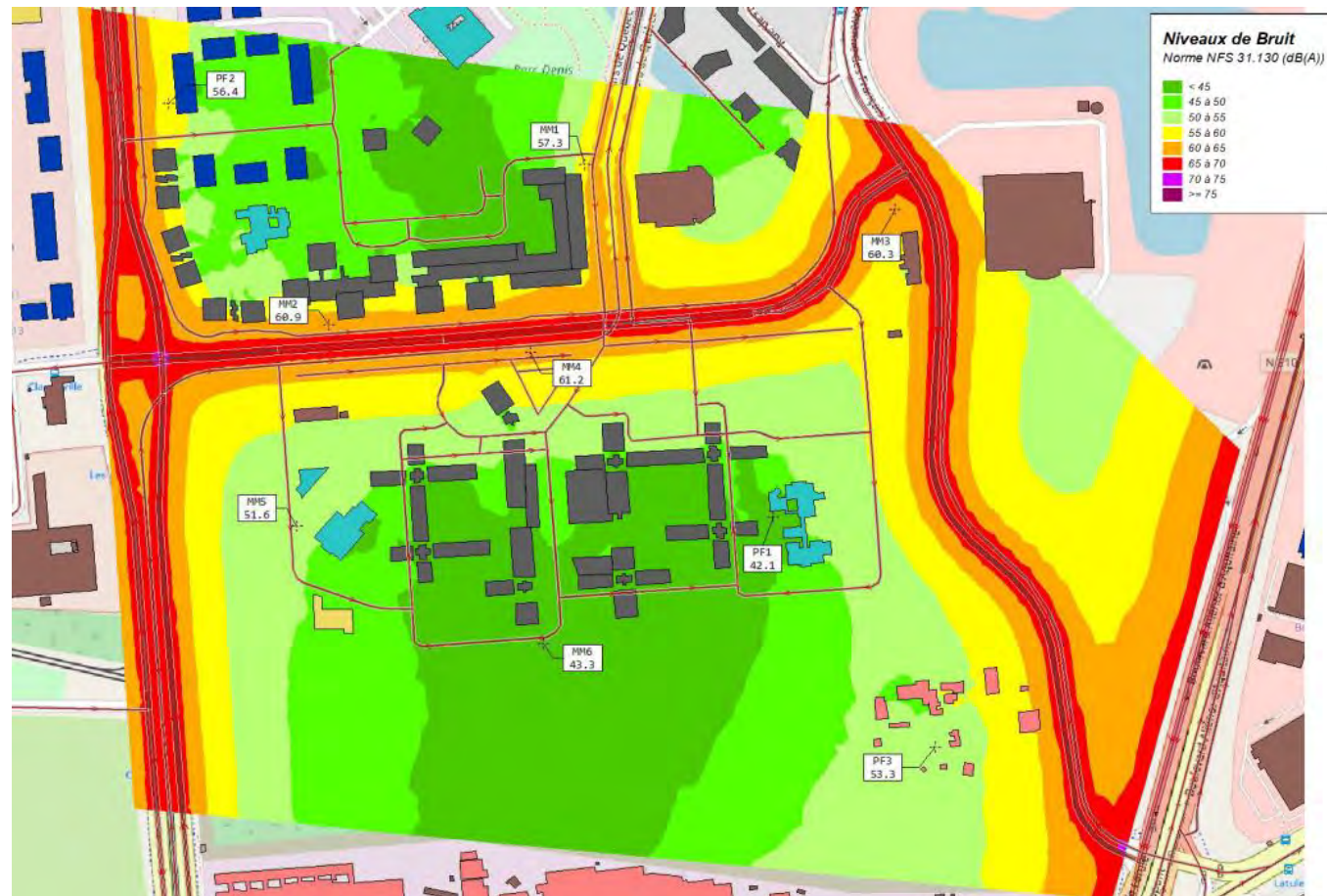
Carte du bruit diurne en situation TMJA 2018 à 4 mètres du sol (source : étude acoustique TPFI)
