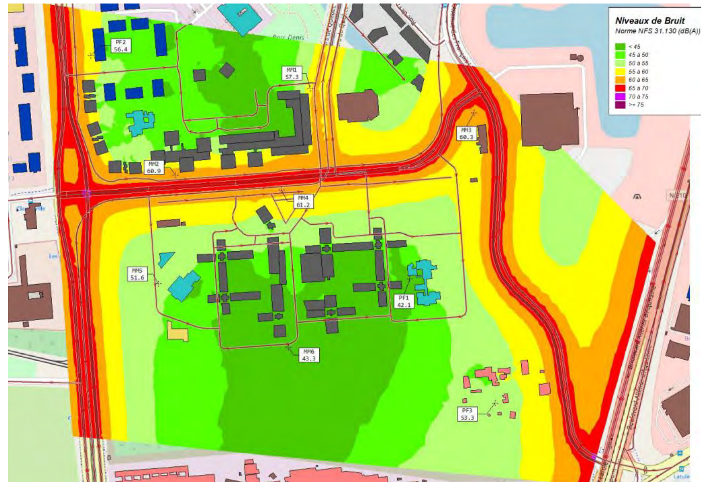
Carte du bruit diurne en situation TMJA 2018 à 4 mètres du sol (source : étude acoustique TPFI)
