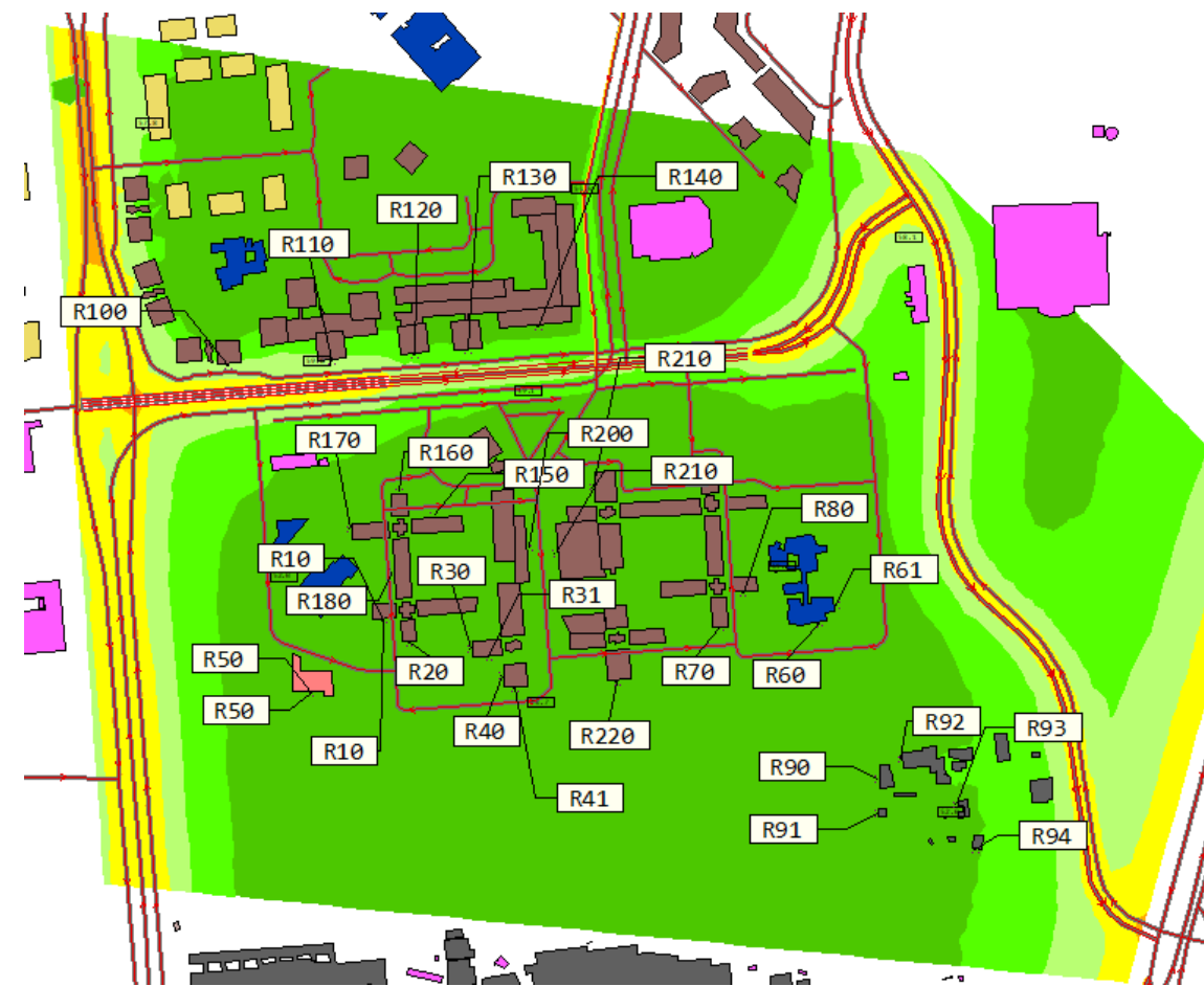
Figure 17 : cartographie sonore sans projet de renouvellement urbain à l'horizon à terme Période nocturne (22h-6h)
