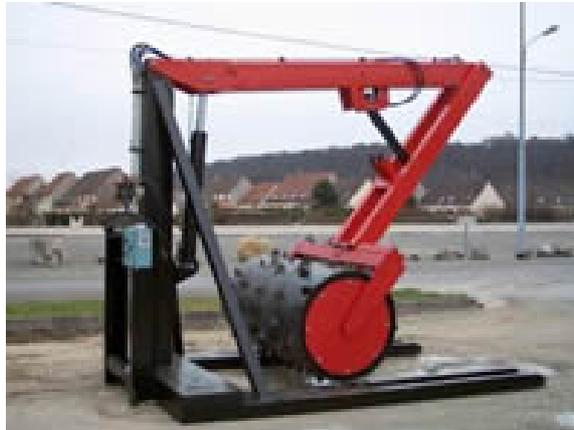
Rouleau de compaction monté sur engin de manutention
