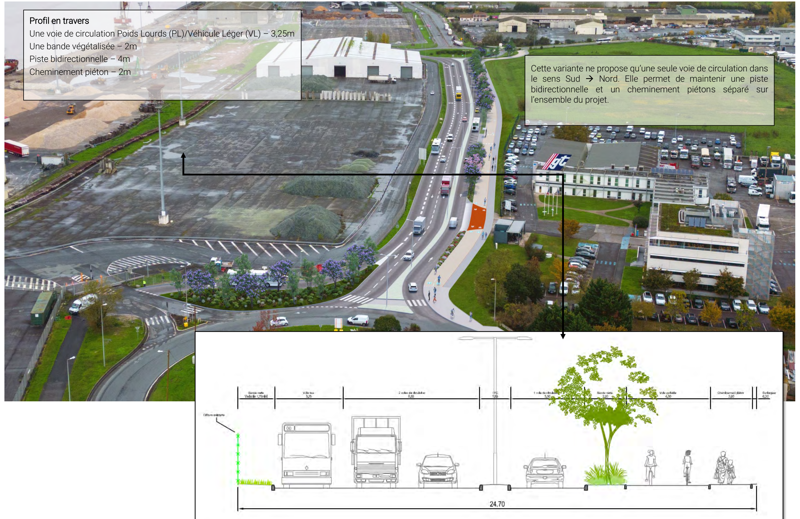
Figure 3- Profil en Travers
