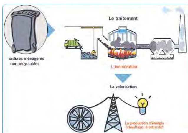
Figure 106 : Schéma de valorisation des déchets
