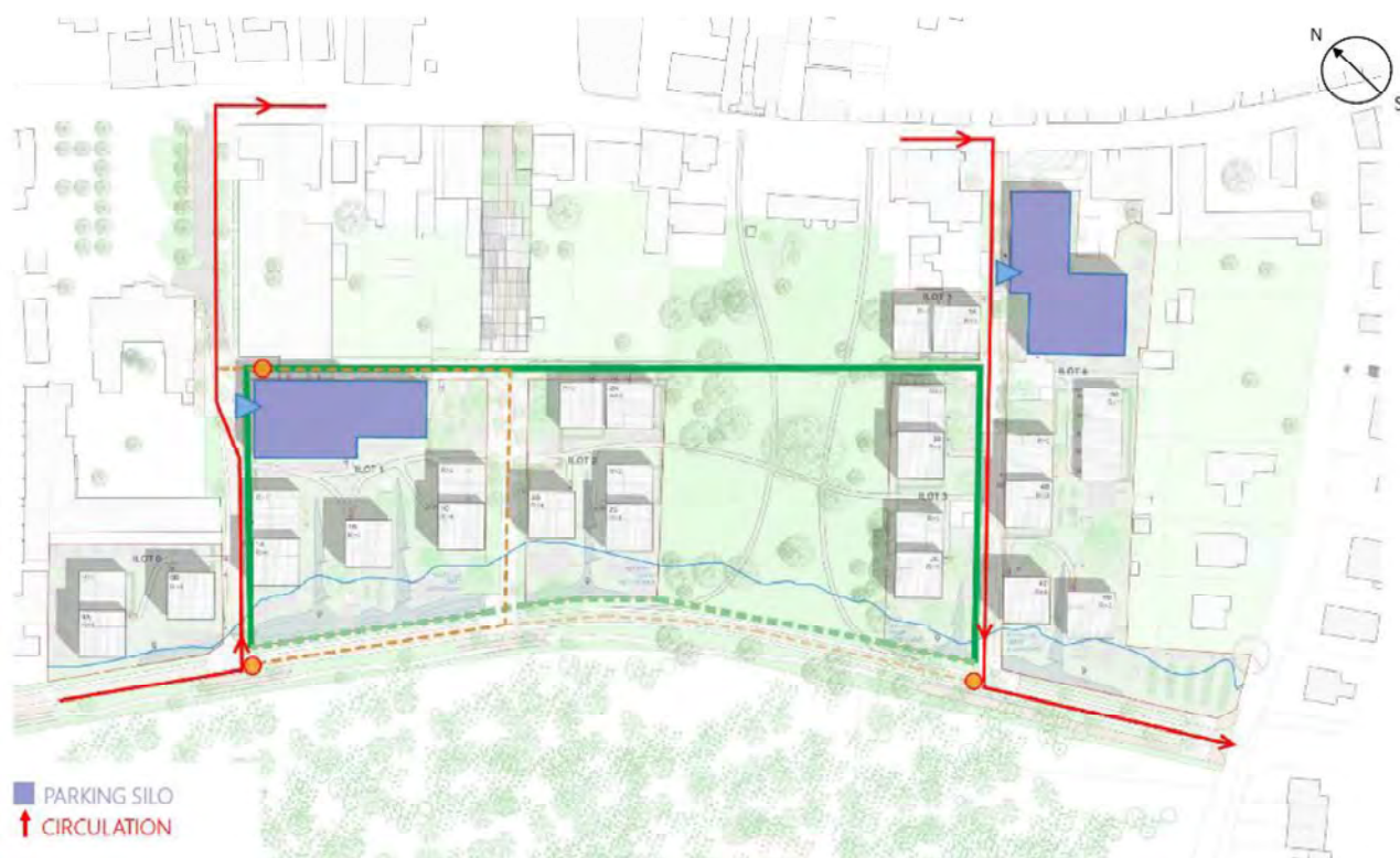
Figure 167 : Plan de principe des circulations en période normale
