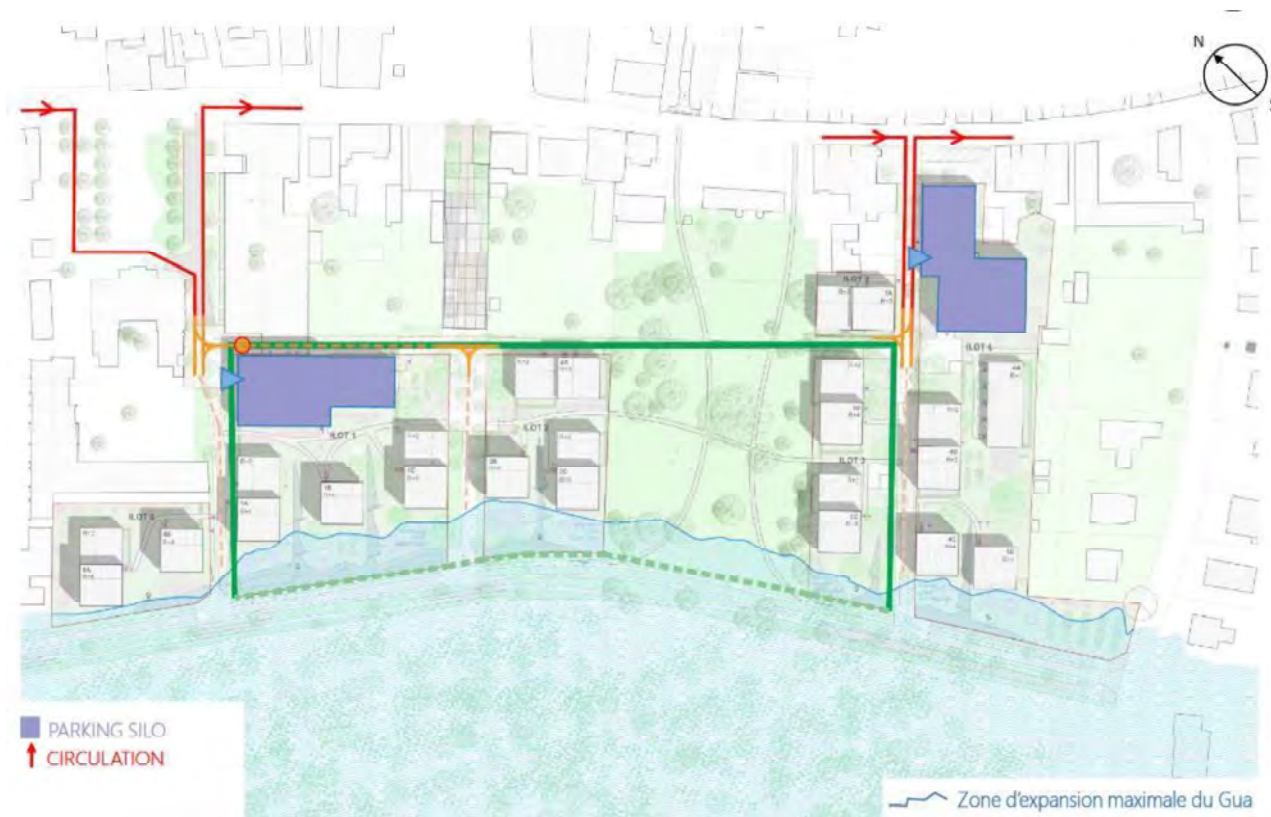
Figure 168 : Plan de principe des circulations en période de crue
