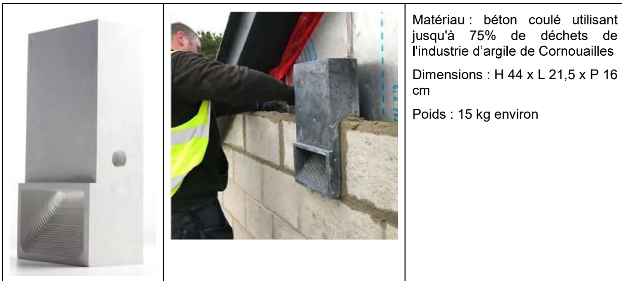
Figure 175 : Gîte à chiroptères encastrable
