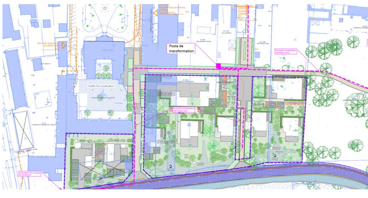
Plan de principe du réseau électrique du secteur A de la ZAC Centre-Ville- Source IRIS Conseil
