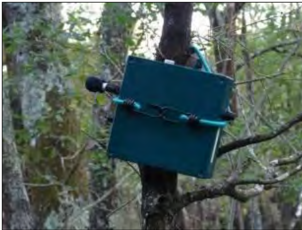
Station fixe d'enregistrement automatique des signaux de chiroptères avec système SM2BAT. Le dispositif est fixé sur un arbre. Photo : Ecosphère
