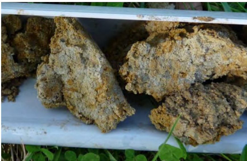
Figure 49 : Traits rédoxiques observés sur les profils pédologiques du site d'étude
