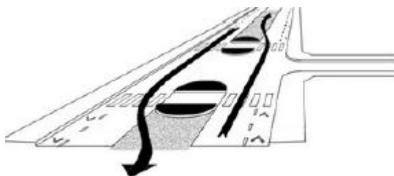
Figure 8 : schéma de fonctionnement d'une voie unique Busway - source : Nantes-métropole
