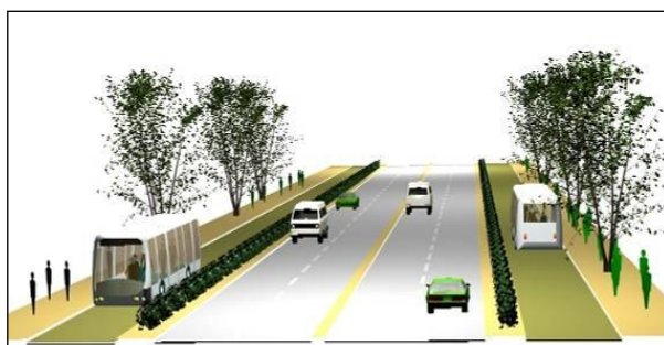
Figure 1 : Vue d'un site propre bilatéral - source : SYSTRA
