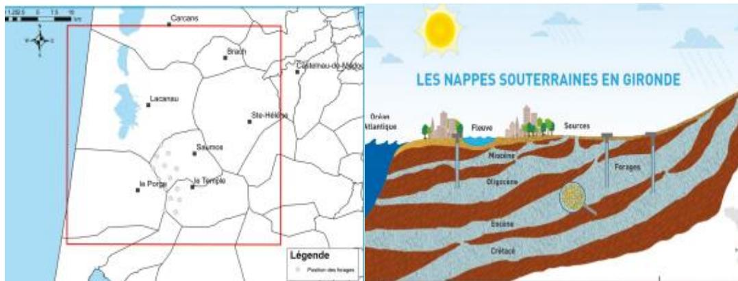
**Définition d'un champ captant :** un champ captant est un ensemble de forages, fonctionnant conjointement pour capter l'eau d'une même nappe et acheminer l'eau jusqu'à une station de pompage.
