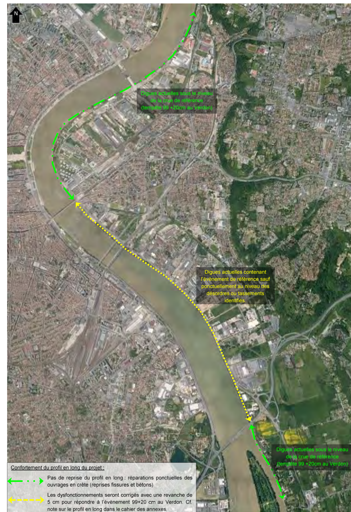
Figure 24 : Synthèse des reprises sur le profil en long de l'ensemble du linéaire de confortement
