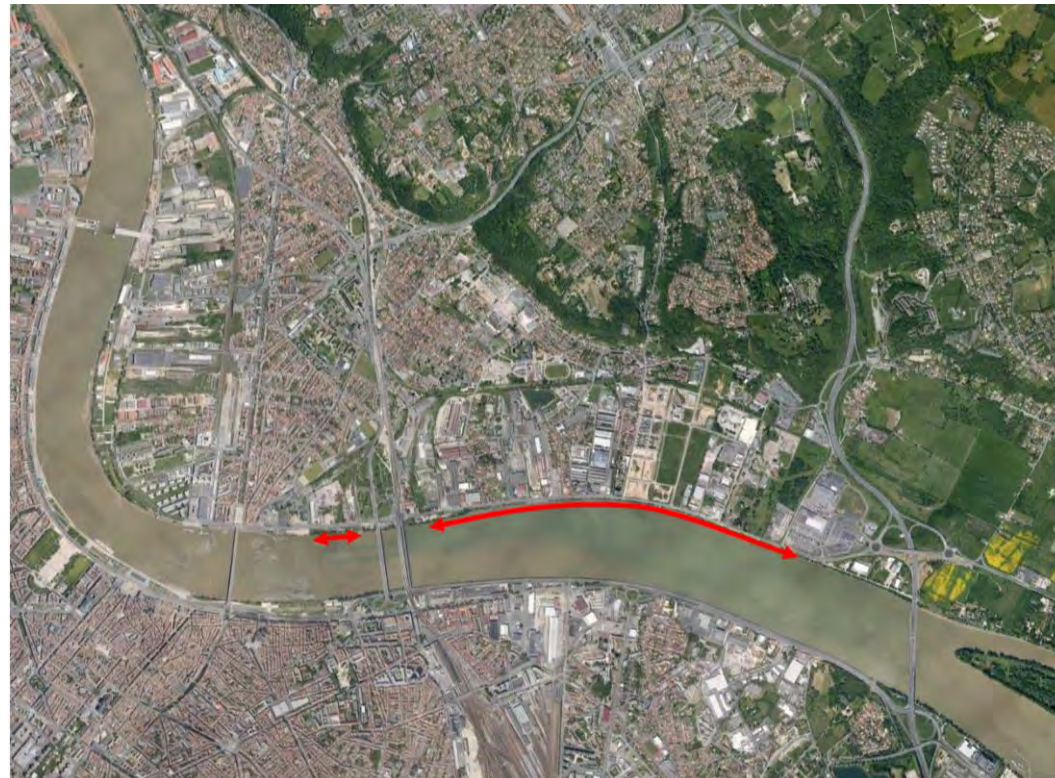
Figure 10 : Linéaire concerné par des protections de talus sous-fluviaux contre l'érosion
