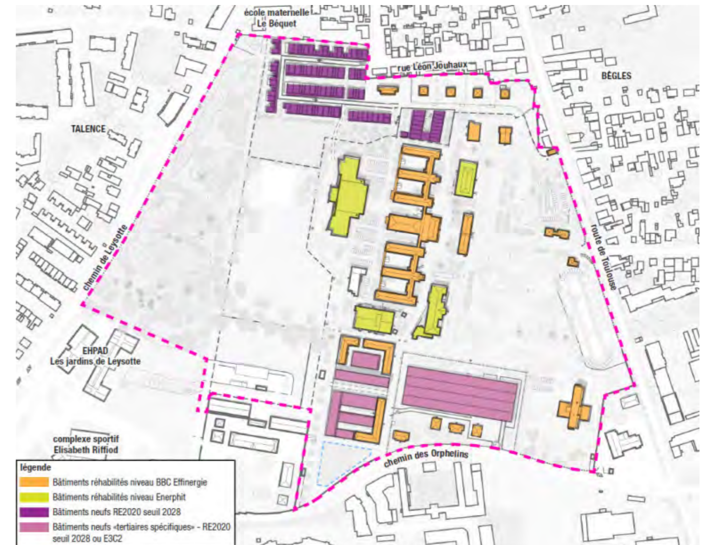
Performances énergétiques envisagées sur les bâtiments - Source : Plan guide, groupement Anyoji Beltrando, juin 2023
