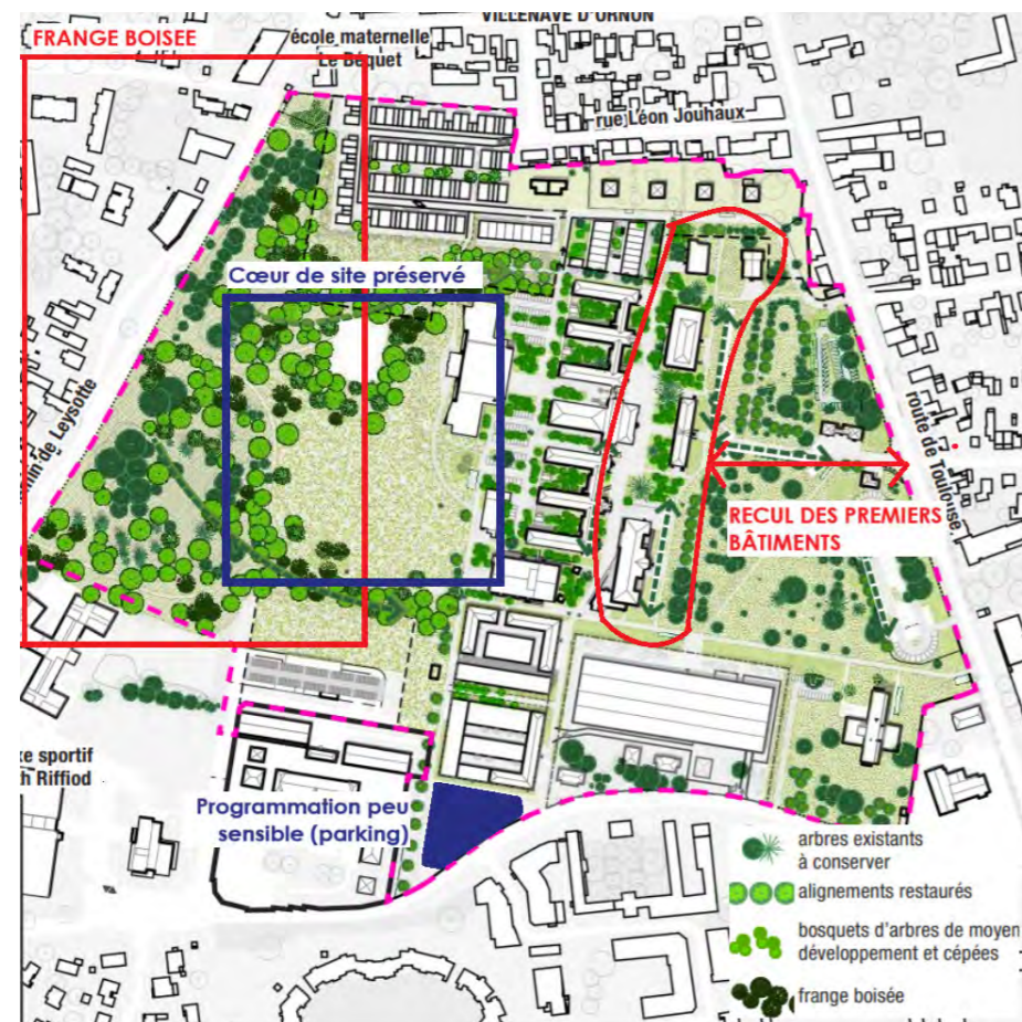
Exemple de dispositions prises pour limiter les nuisances sonores, Source : d'après le Plan guide, Site du HIA Robert Picqué, groupement Anyoji Beltrando - Atelier Roberta - Alphaville - ALTO STEP - ATM - Khephren, Décembre 2023
