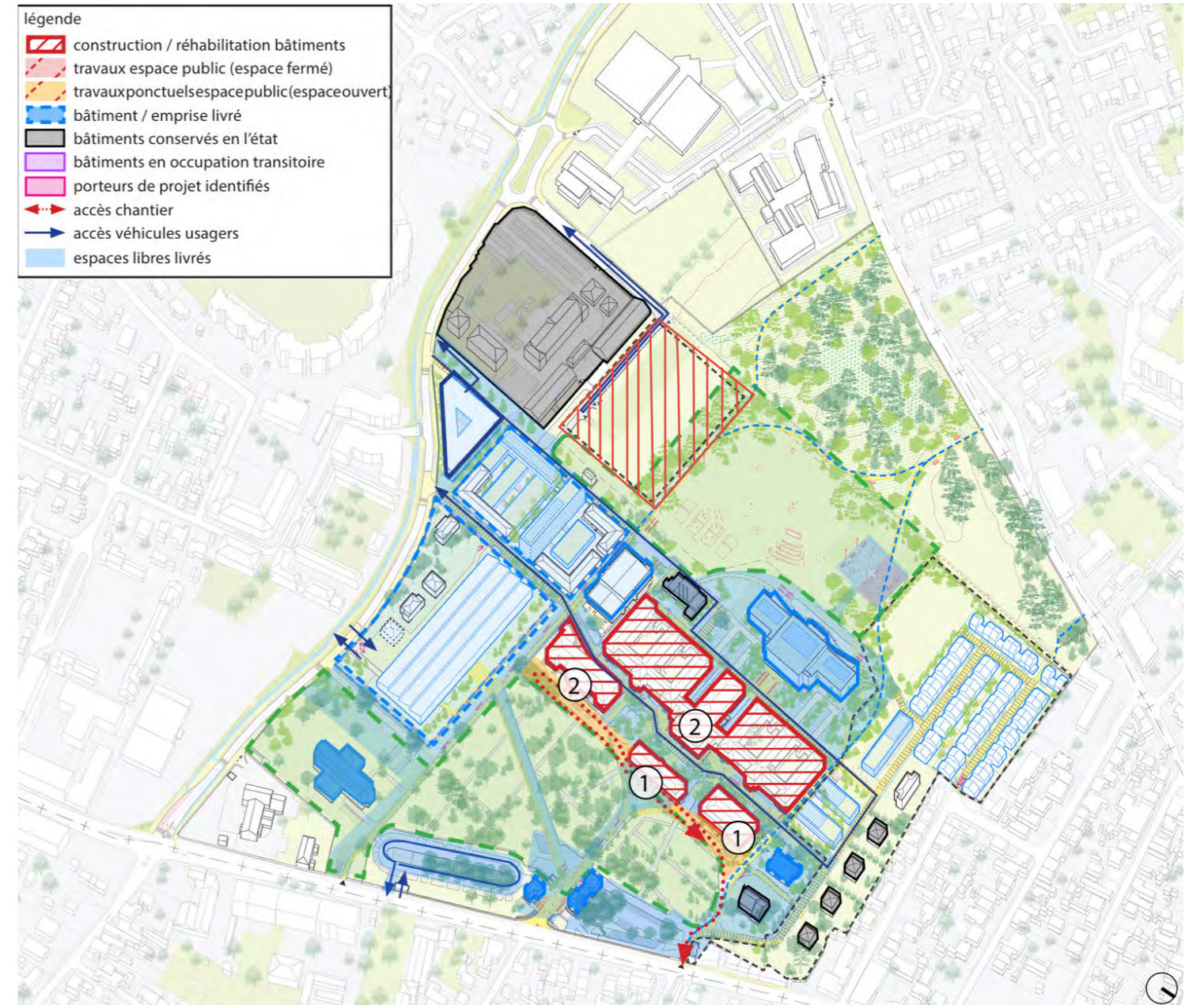
Plan de phasage - Phase 3, Source : Plan guide, Site du HIA Robert Picqué, groupement Anyoji Beltrando - Atelier Roberta - Alphaville - ALTO STEP - ATM - Khephren, Juin 2023
