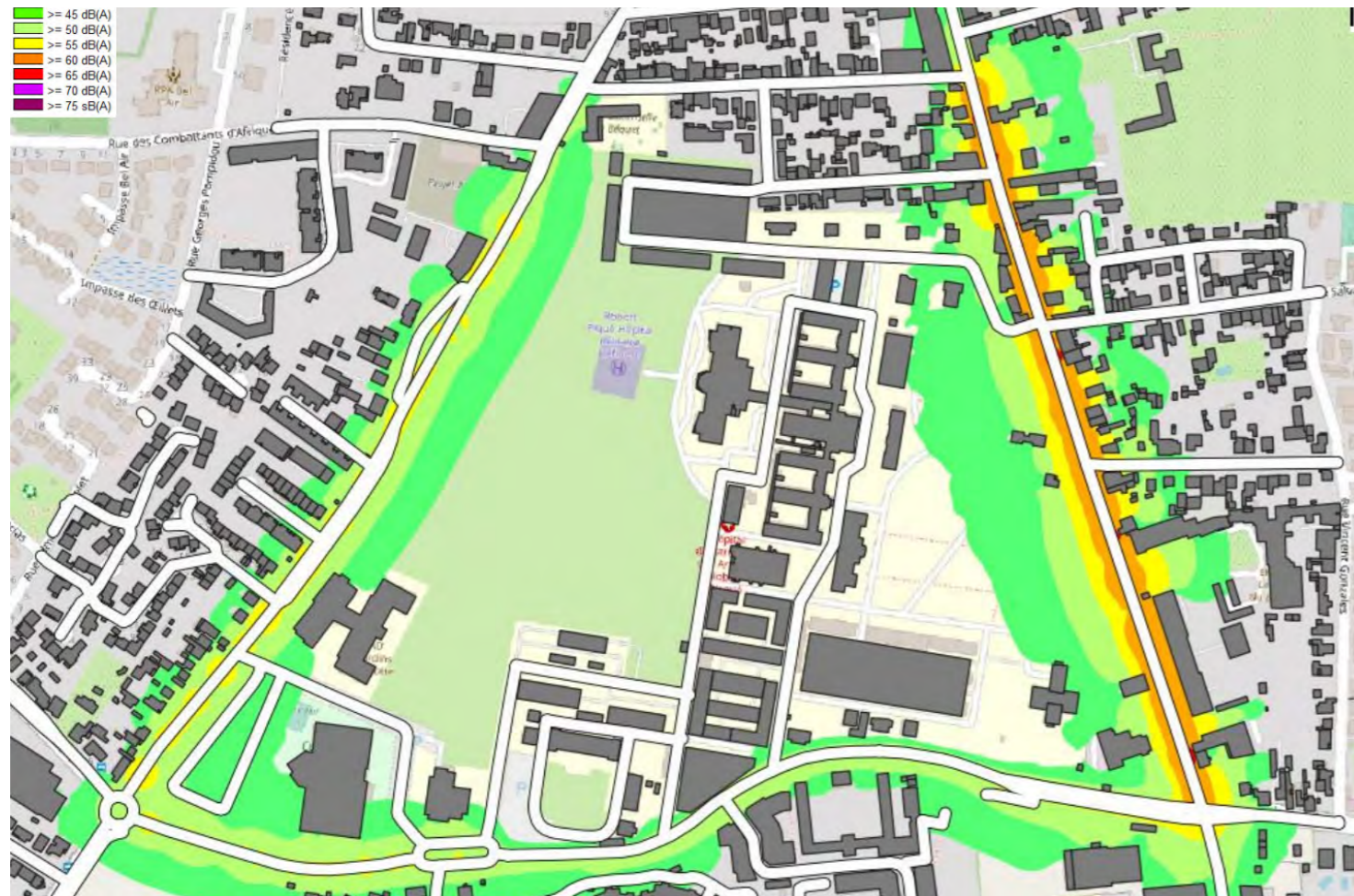
Modélisation des niveaux sonores LAeq Nuit en l'état projeté - Source : Étude Acoustique (ORFEA, décembre 2023)
