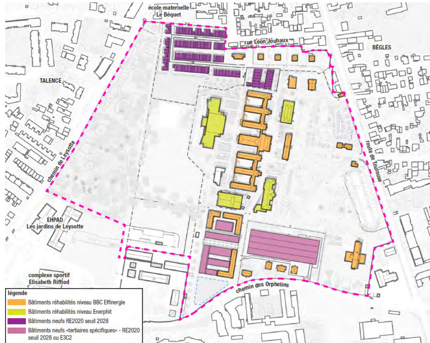
Performances énergétiques envisagées sur les bâtiments - Source : Plan guide, Site du HIA Robert Picqué, groupement Anyoji Beltrando - Atelier Roberta - Alphaville - ALTO STEP - ATM - Khephren, Juin 2023
