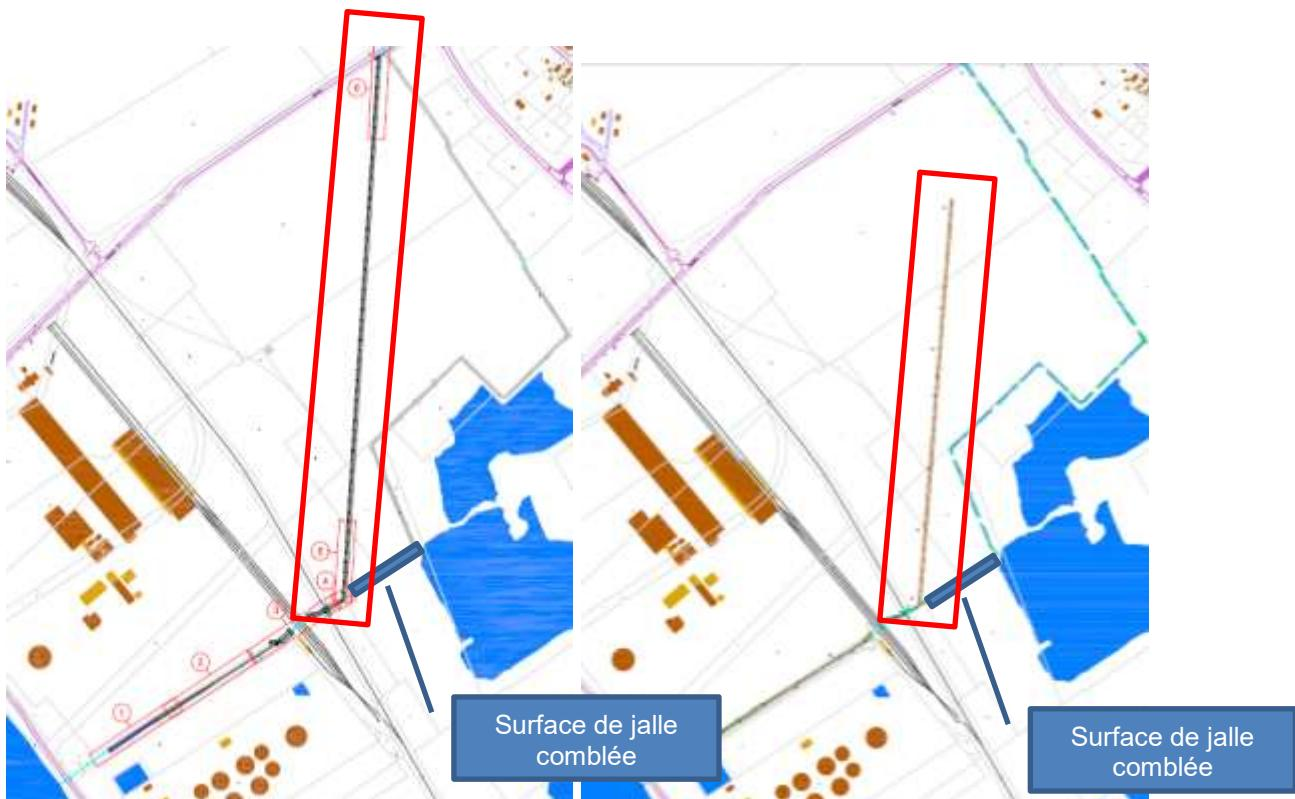
Tracé initial (longueur de 1085m, surface de jalle créée de 5800m<sup>2</sup> + surface de jalle comblée de 850m<sup>2</sup>) Tracé optimisé (longueur de 820 m, surface de jalle créée de 4600m<sup>2</sup>+surface de jalle comblée de 850m<sup>2</sup>)
