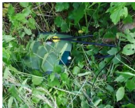
Enregistreur automatique de type SM2 in situ
