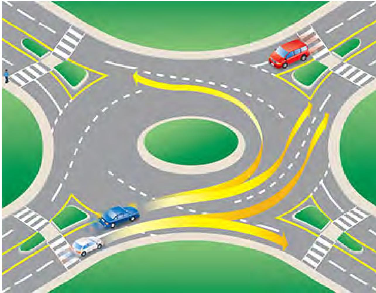
Avec le passage à 2 files en entrée : 2 véhicules peuvent démarrer de front mais surtout, le temps entre 2 véhicules diminue (pendant que l'un s'avance au cédez le passage, l'autre démarre) A condition de trafic équivalent, le gain pour la branche concernée est généralement de l'ordre de 30%.
