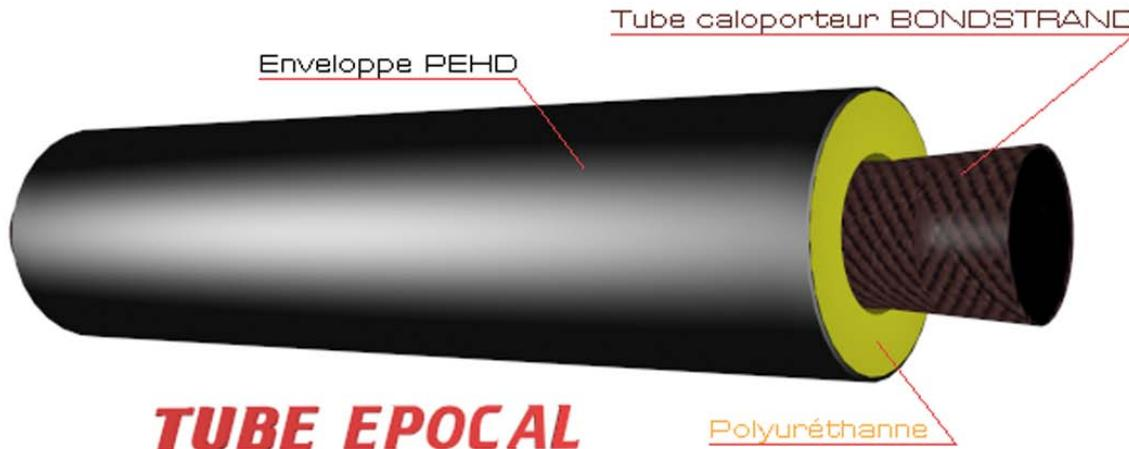
Le tube en résine Epoxy précalorifugé ÉPOCAL® est constitué de :
