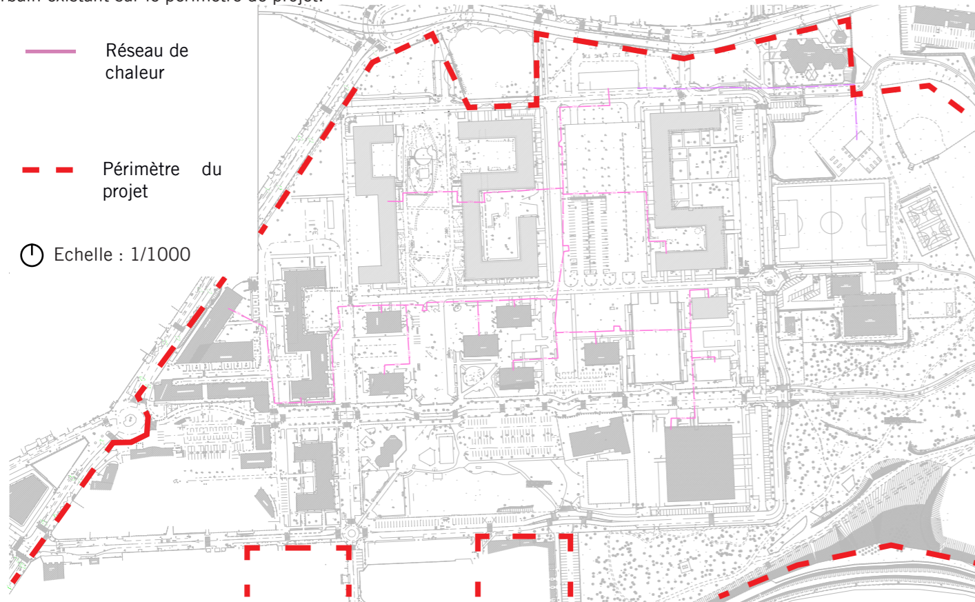
Réseau de chaleur existant sur Saige - Source : Alto Step, 2024
