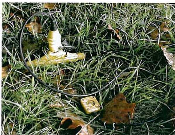
Géophone relié à la flûte sismique
