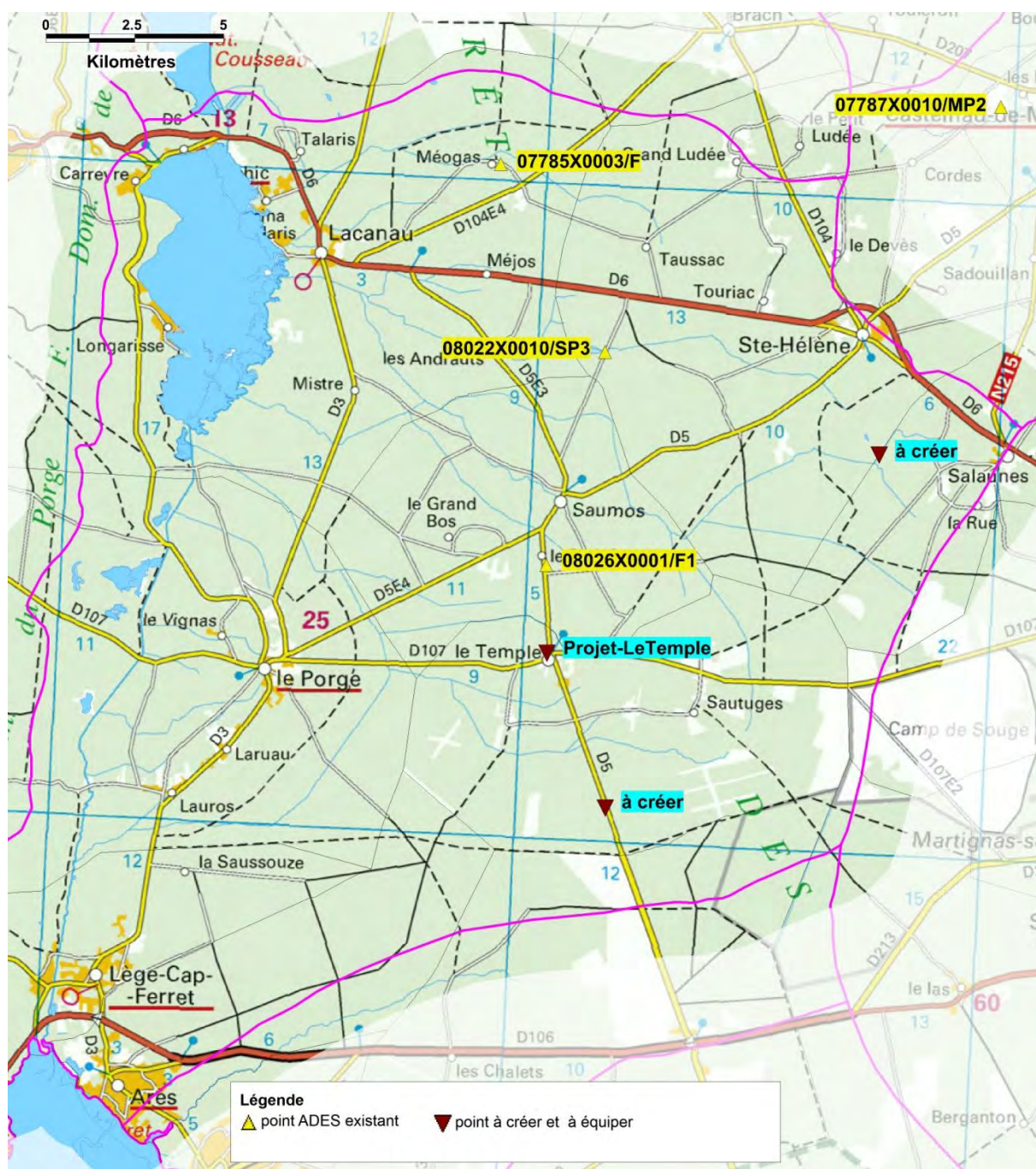
Figure 5 : réseau de piézomètres au Miocène proposé
