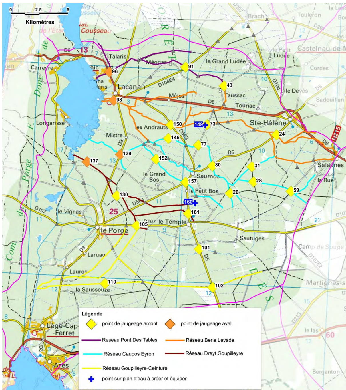
Figure 4 : réseau de mesure proposé sur le réseau hydrographique et les plans d'eau
