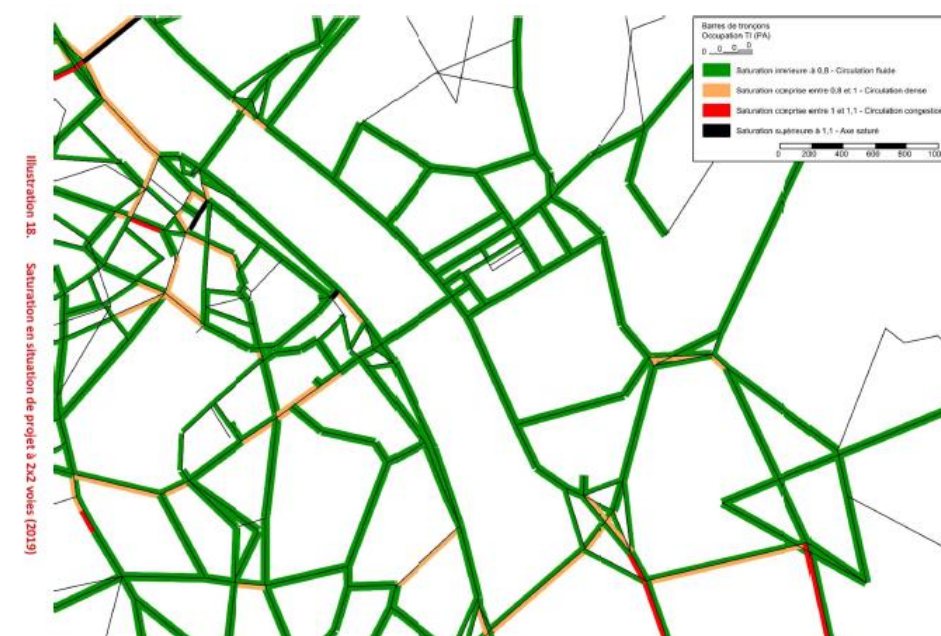
Figure 37 : Niveau de saturation en situation de projet Heure de pointe du soir 2019 (source : Systra)
