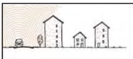
Principe du bâtiment écran
