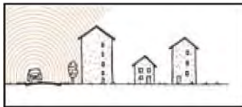
Principe du bâtiment écran
