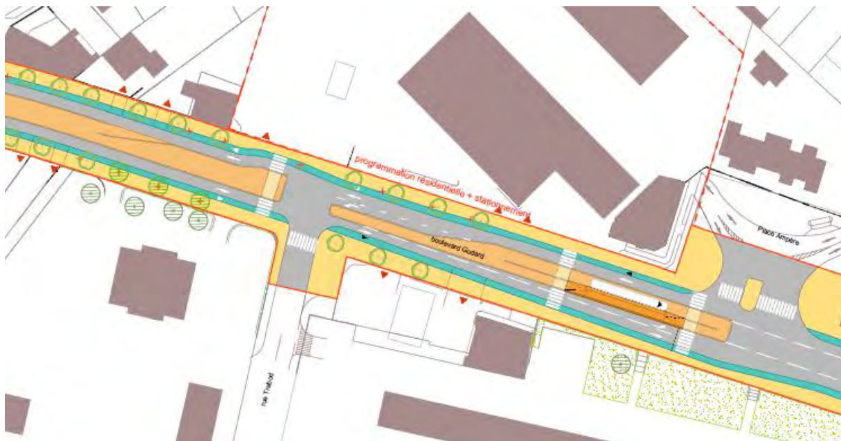
Illustration 112. BHNS axial – Interruption prolongée du site propre dans le sens Nord-Sus au niveau du carrefour Trebod
