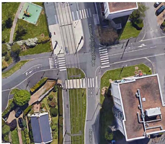
Illustration 57. Exemple d'un carrefour en croix à Joué-lès-Tours avec une voie TD et TAG le long d'un refuge piéton
