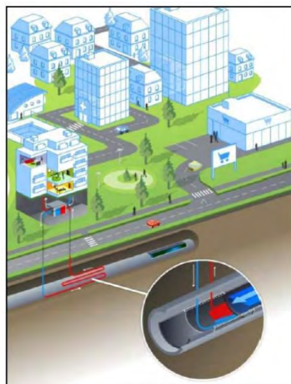
Figure 42 - Installation d'un échangeur dans le collecteur - Degrés bleus Source : CSTB
