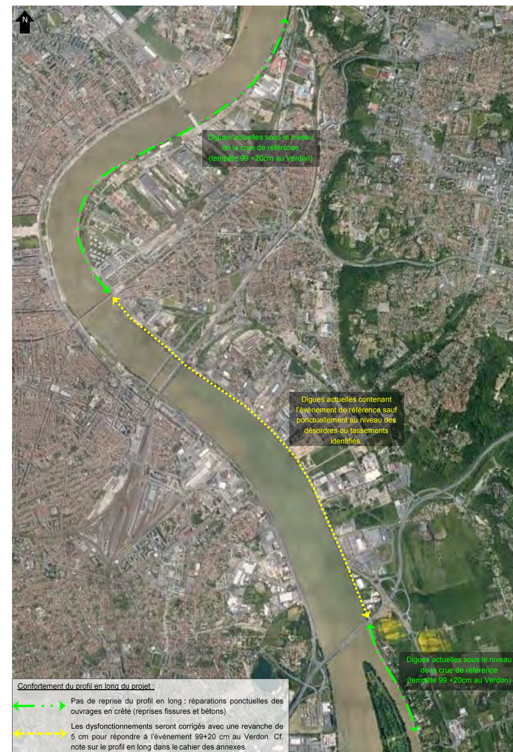
Figure 2 : Synthèse des reprises sur le profil en long de l'ensemble du linéaire de confortement
