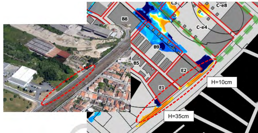
Figure 208 : Impacts localisés en phase 2 rue des Queyries
