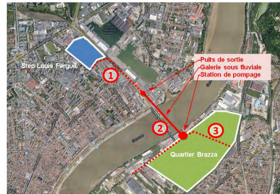
Figure 97 : Création d'un réseau eaux usées sous la Garonne (source : Bordeaux Métropole, 2017 )
