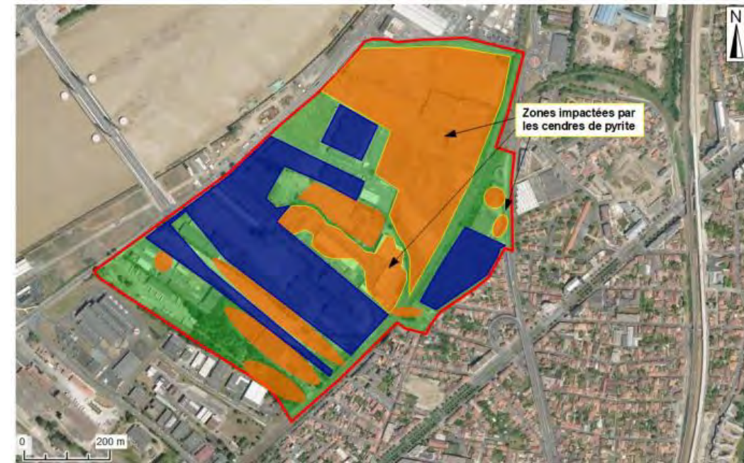
Figure 40 : Zones d'enrichissement en métaux sur l'horizon des remblais (source : Arcagée, novembre 2017)
