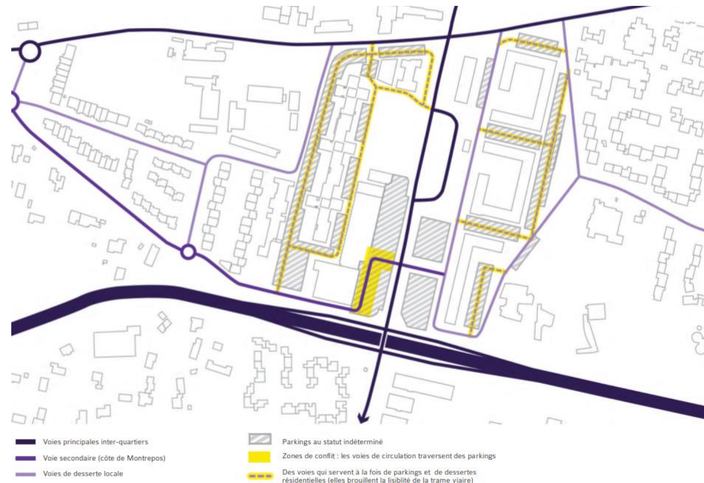
FIGURE 91. SCHEMA ILLUSTRANT LE MANQUE DE LISIBILITE DE LA TRAME VIAIRE DE DRAVEMONT (SOURCE : BORDEAUX METROPOLE)
