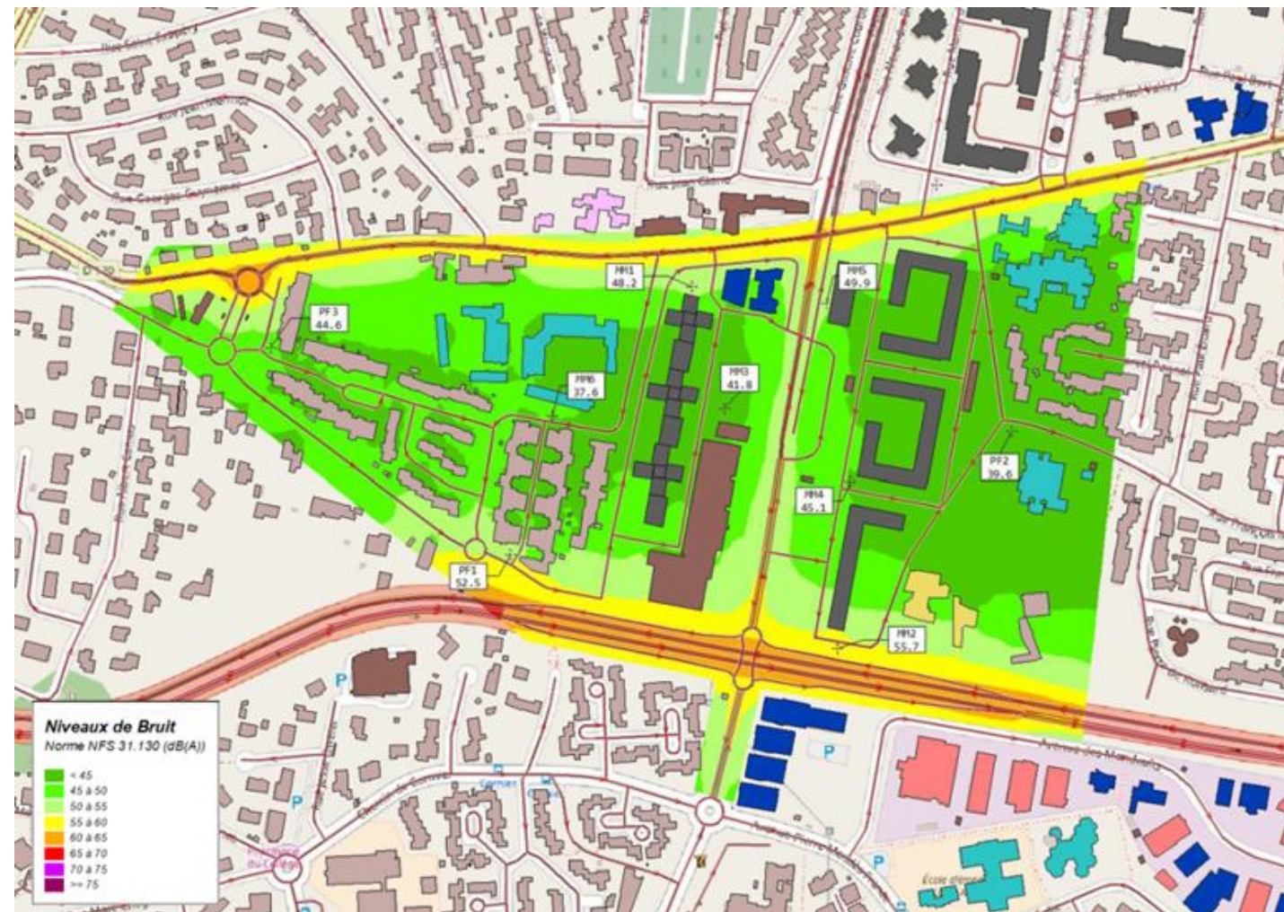
FIGURE 100. EXPOSITION AU BRUIT NOCTURNE EN SITUATION ACTUELLE TMJA 2018 A 4 METRES DU SOL (SOURCE : TPF INGENIERIE)
