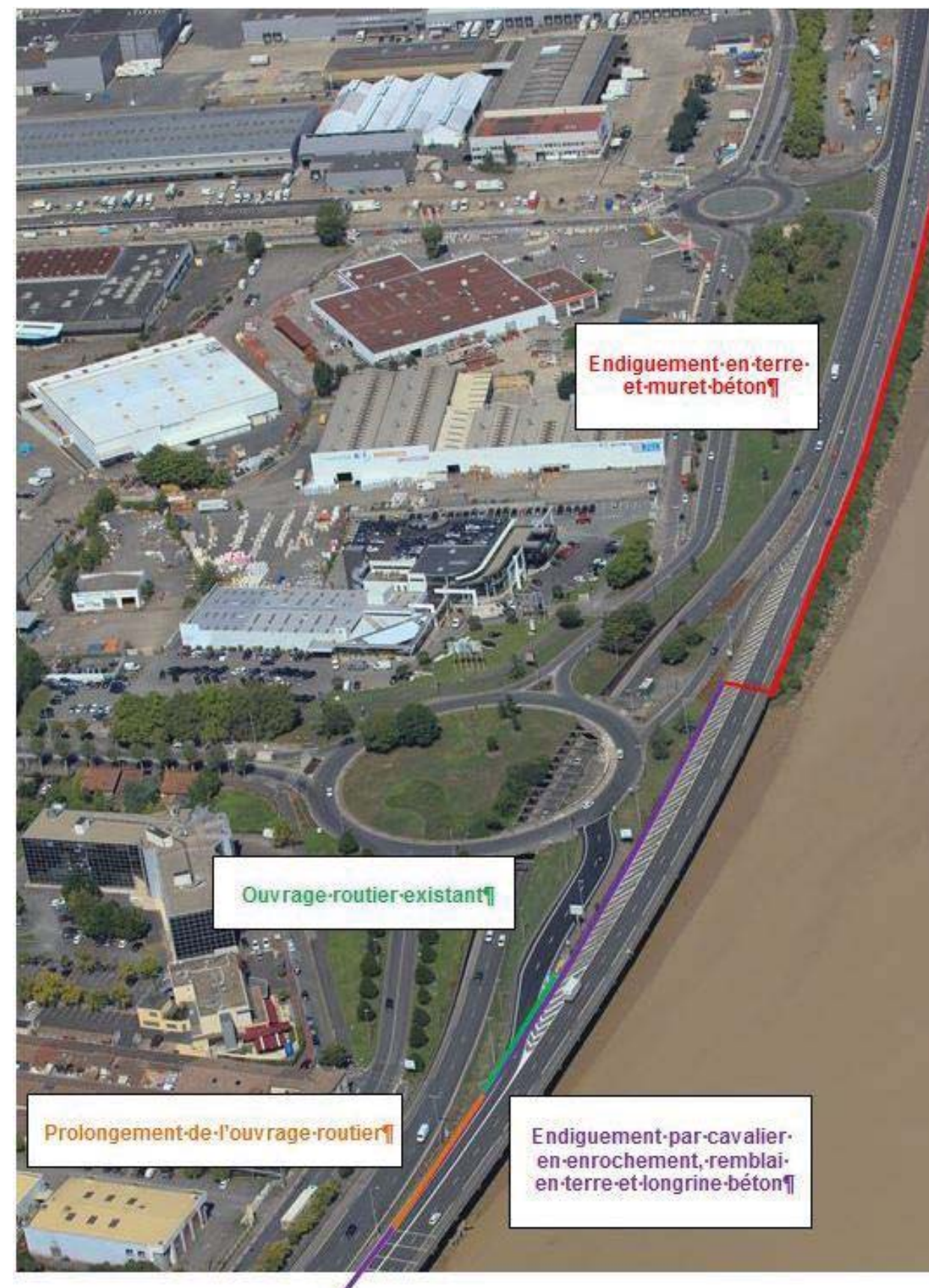
Schéma de principe des travaux en rive gauche
