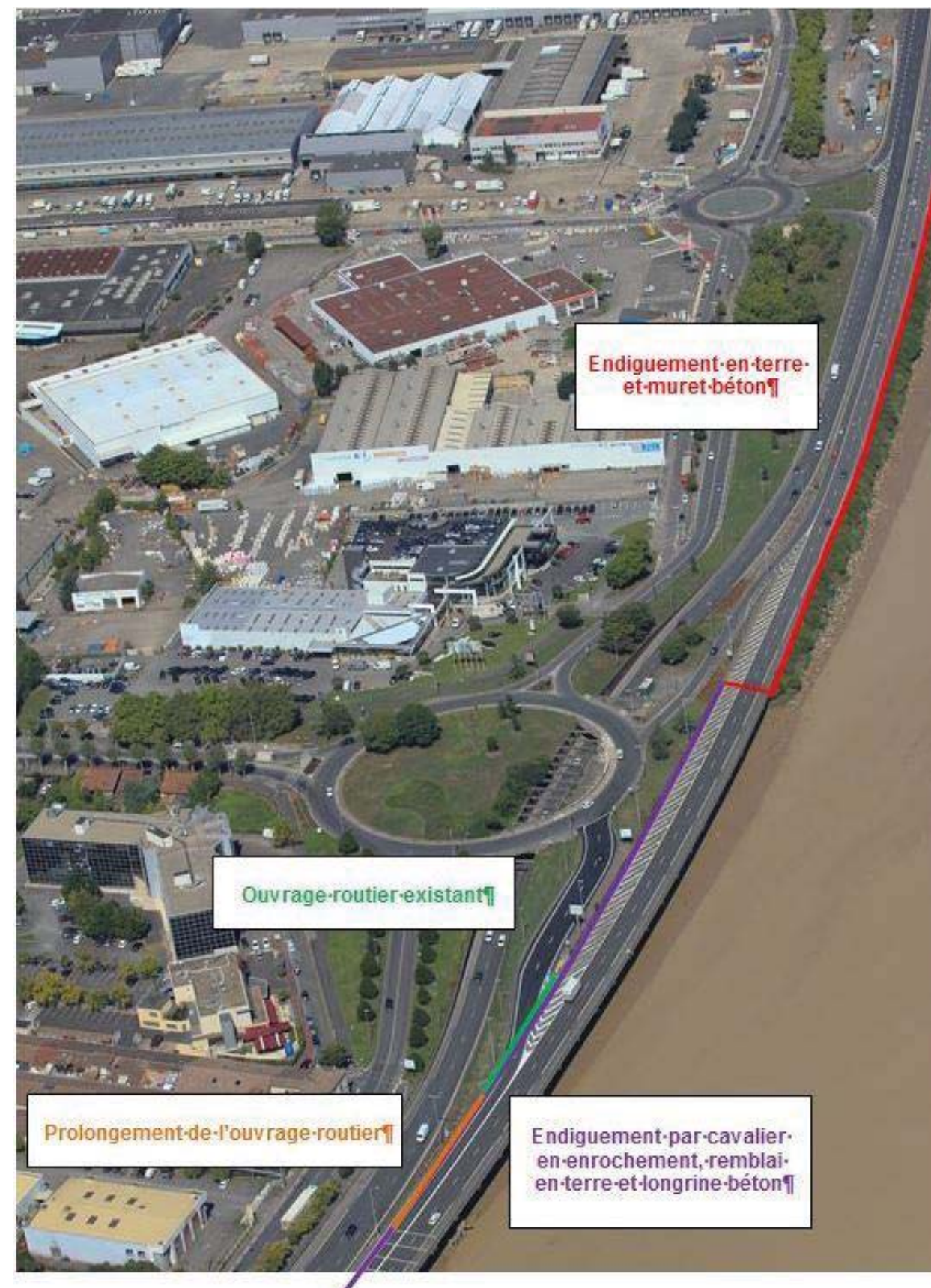
Schéma de principe des travaux en rive gauche
