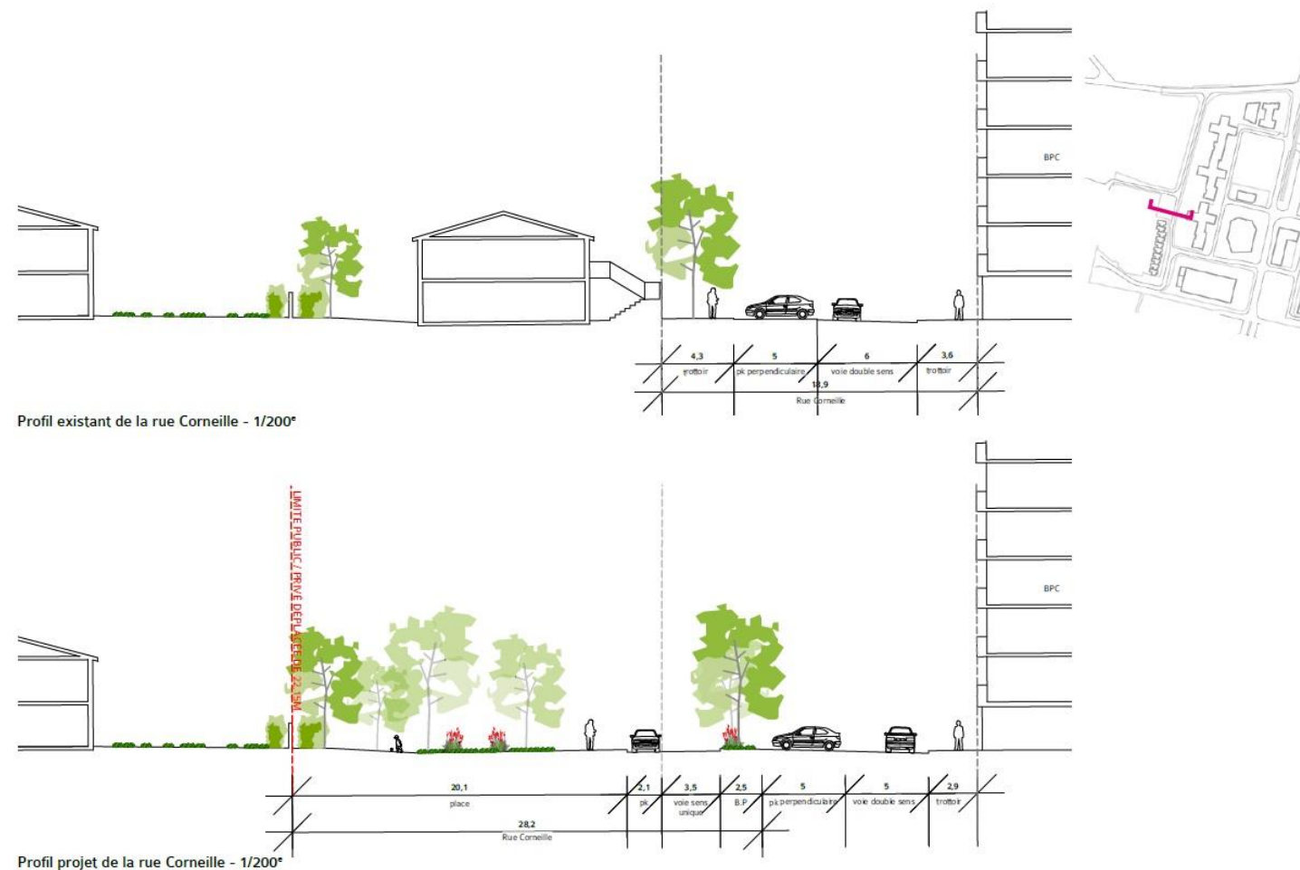
FIGURE 46. PLAN DE SITUATION ET COUPE DE L'AMENAGEMENT PROJETE SUR LA RUE CORNEILLE (SOURCE : BORDEAUX METROPOLE)
